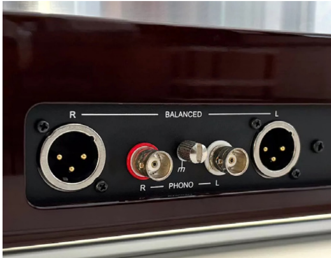
Phonosophie ersetzt die ursprünglichen Cinch-Buchsen durch hochwertige BNC-Anschlüsse.
