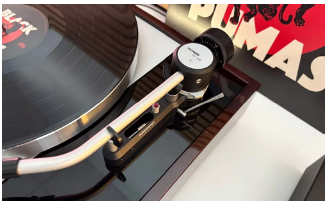
Bewährte Qualität: Den Thorens Tonarm TP 150 inklusive SME-Schraubverschluss hat Phonosophie unangetastet gelassen. Die Einstellung des Auflagegewichtes ist kinderleicht und die Anti-Skating-Lösung beeindruckend.
