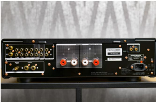
Der MR Model 30 bietet selbst Gerätesammlern ausreichend Anschlussmöglichkeiten. Dazu gehört auch ein Phono-Input für MM- und MC-Tonabnehmersysteme.
