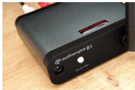
Für das Pairing mit dem Smartphone muss die Taste an der Front einige Sekunden gedrückt werden. Die Farbe der LED weist dann auf den genutzten Codec hin.
