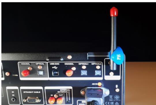
E64-Clip an einer WLAN-Antenne eines HiFi-Gerätes.
